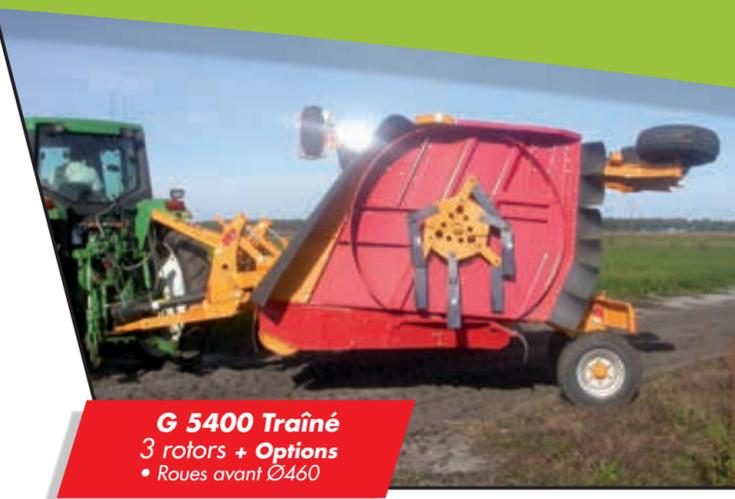
> Hauteur de coupe à réglage hydraulique, parallèle au sol ou avec l'avant du broyeur plus haut que l'arrière sur chantiers pierreux
