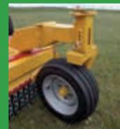
Roue neuve Ø 600, largeur 200 Type 200.60x14,5 - 10 PLYS Adaptée au pivotement 360°
