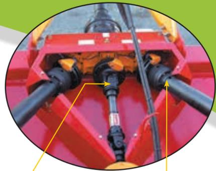
L'accessibilité rapide aux cardans facilite le graissage (croisillons + tubes)
