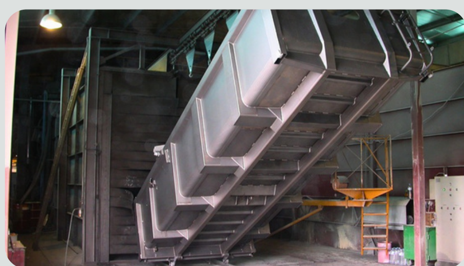
Grenaillage intégral + antirouille + peinture polyuréthane = brillance et longévité
