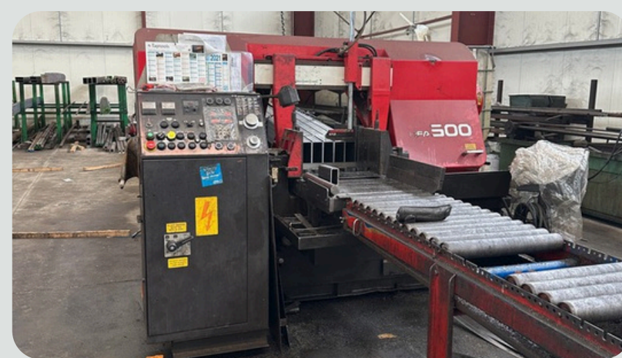
Découpe des tubes pour les châssis
