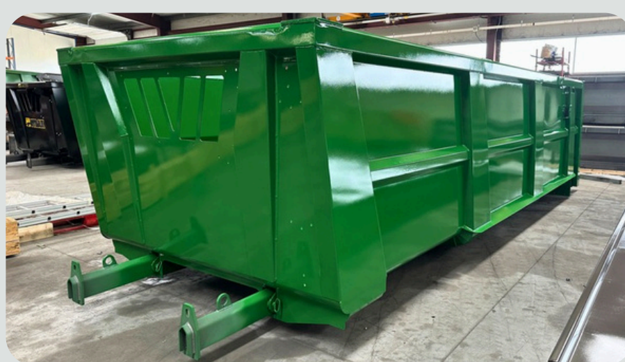
Grenaillage intégral + antirouille + peinture polyuréthane = brillance et longévité
