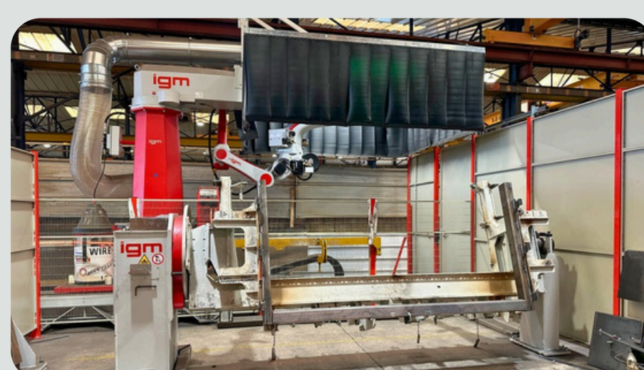
Robot de soudure 3 postes automatiques
