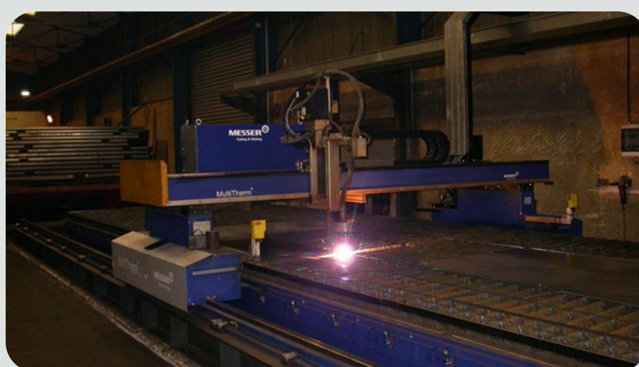
Découpe précise par laser et plasma
