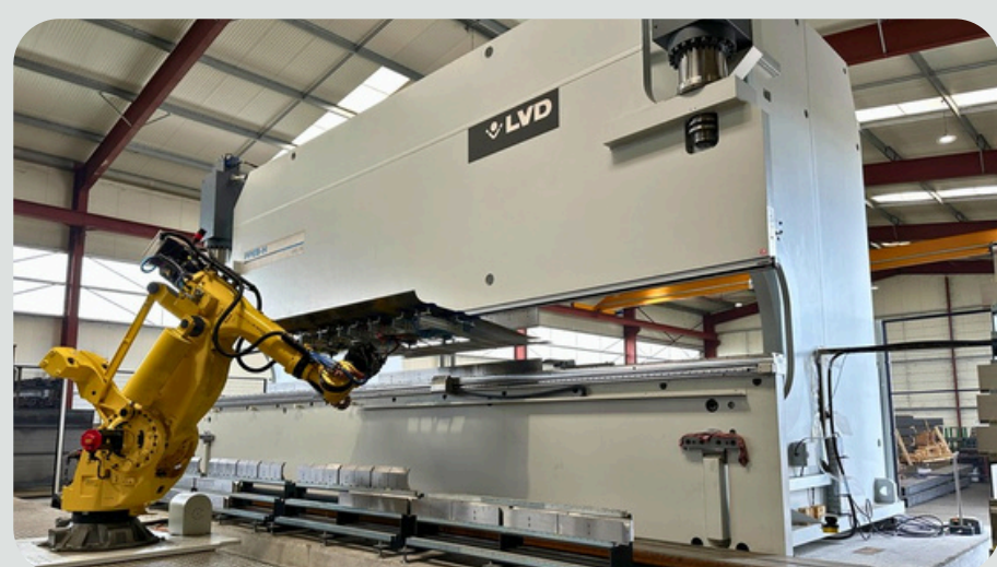
Plieuse Robotiser de 600 tonnes 10M
